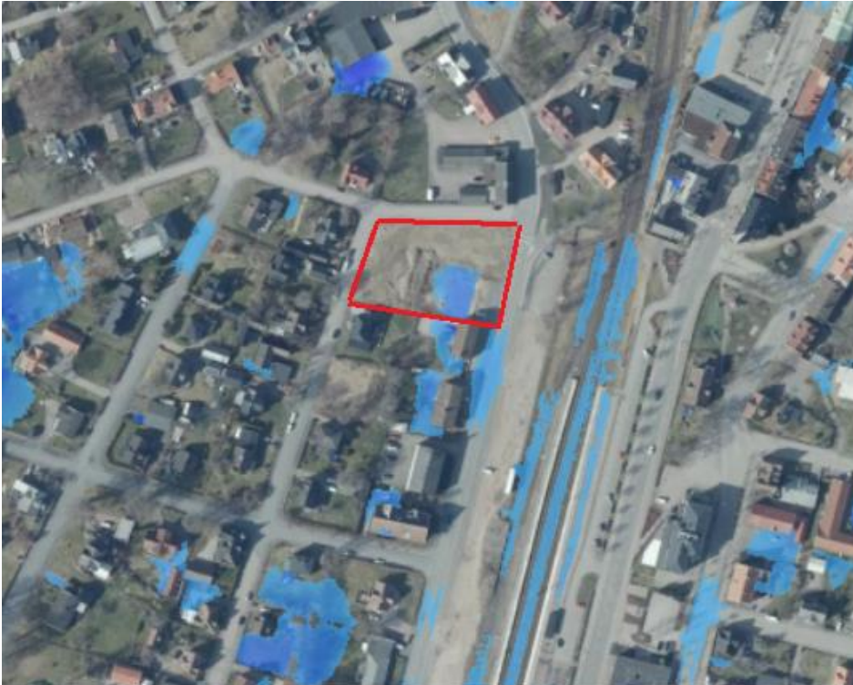
Figur 7 Lågpunktsanalys utförd i SCALGO Live. Figuren visar ytliga skyfallsstråk som har en tillrinnande area på minst 0,5 ha samt uppfyllnad av lågpunkter vid studerad regnvolym 65 mm. Planområdets ungefärliga gräns markerat i rött.
