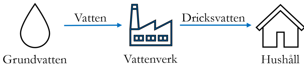
Figur 2. Grundvatten tas upp från grundvattenmagasin i kommunen och pumpas till vattenverken där kvaliteten på dricksvattnet säkerställs. Dricksvattnet leds sedan i ledningar till kommunens alla hushåll.
