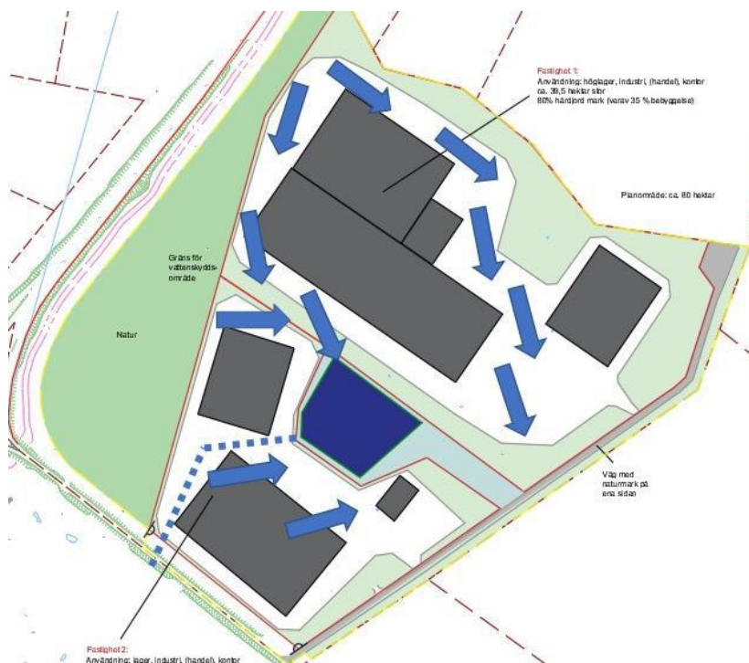
Figur 3, Bild från dagvattenutredningen: bilden visar principiell höjdsättning av kvartersmarken för att säkerställa att vattnet rinner från vattenskyddsområdet och mot våtmarken i mitten av planområdet.
